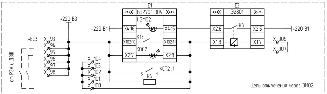
X60\*, X61\* - перемычку между клеммами убрать для схем управления без контроля цепи включения.
